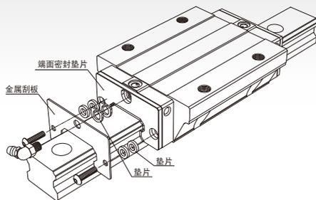
可排除高温铁屑与焊接火花等大型异物，并防止端面密封垫片因而被破坏之配件。
